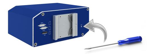
Figure 33: Router reset
